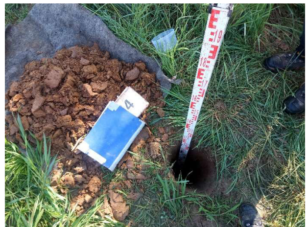
Foto 4: Handschurf und Aushub bei RKS 4 / DPH 3
