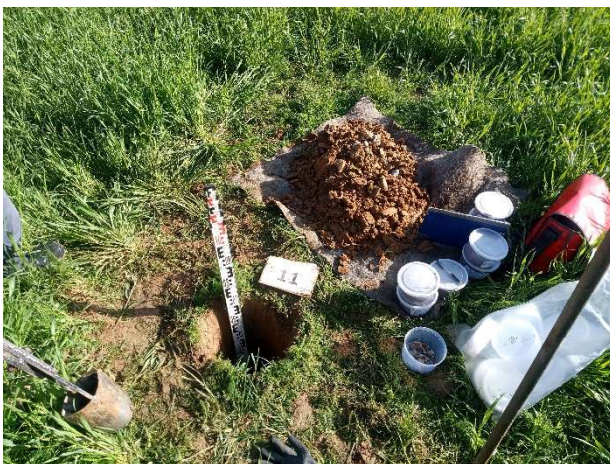
Foto 11: Handschurf und Aushub bei RKS 11
