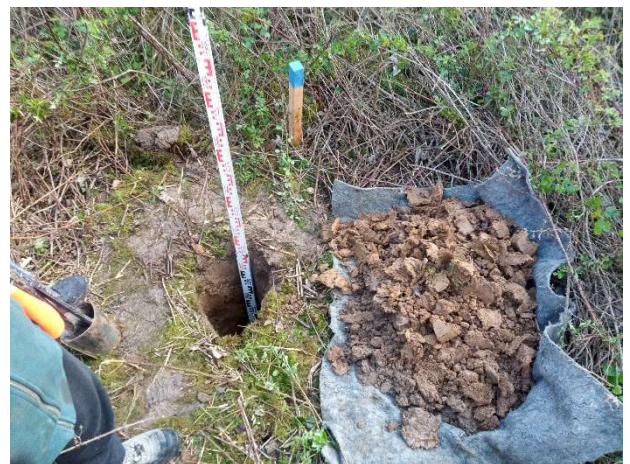
Foto 12: Handschurf und Aushub bei RKS 12
